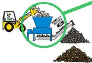
2軸破碎機による廃棄物の破碎
